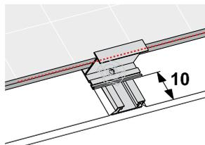
Positionieren des Modulhalters auf dem Vertikalprofil
