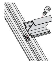
Montage des Modulhalters auf dem Vertikalprofil
