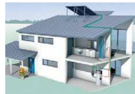
Zonnepanelen voor de productie van warm sanitair water in combinatie met de warmtepomp voor de productie van warm sanitair water BWP 30 HLW en AWP 30 HLW
